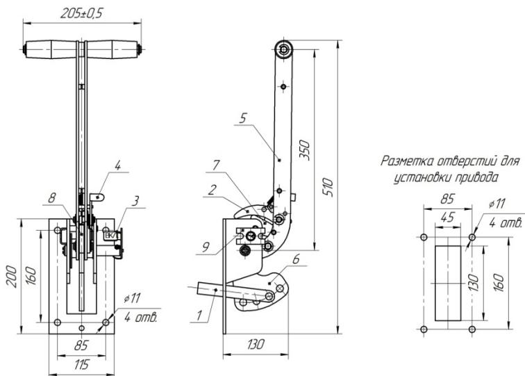
1-вилка ВПУ; 2-отключающая «собачка»; 3-указатель положения; 4-рычаг отключения; 5-рукоятка; 6-секционный рычаг; 7-защелка; 8-расцепляющая собачка; 9-кронштейн для установки блок-замка.
