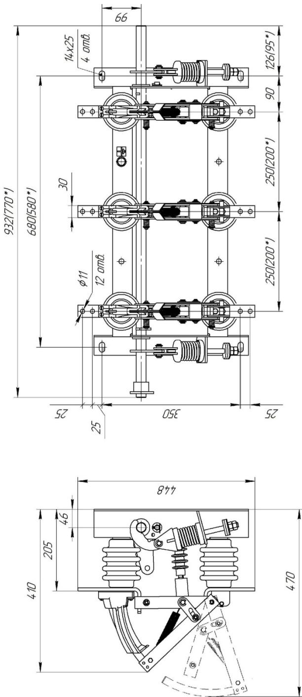
\* – размеры в скобках для выключателя с межполюсным расстоянием 200 мм (изготавливается по заказу)
