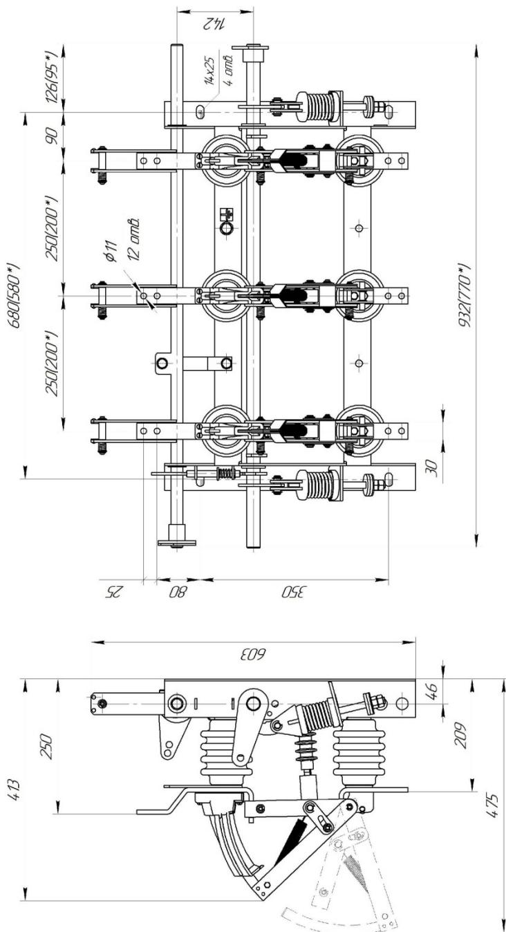
\* – размеры в скобках для выключателя с межполюсным расстоянием 200 мм (изготавливается по заказу)
