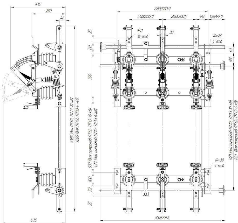
\* – размеры в скобках для выключателя с межполюсным расстоянием 200 мм (изготавливается по заказу)
