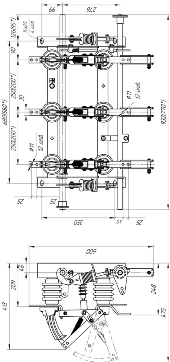
\* – размеры в скобках для выключателя с межполюсным расстоянием 200 мм (изготавливается по заказу)
