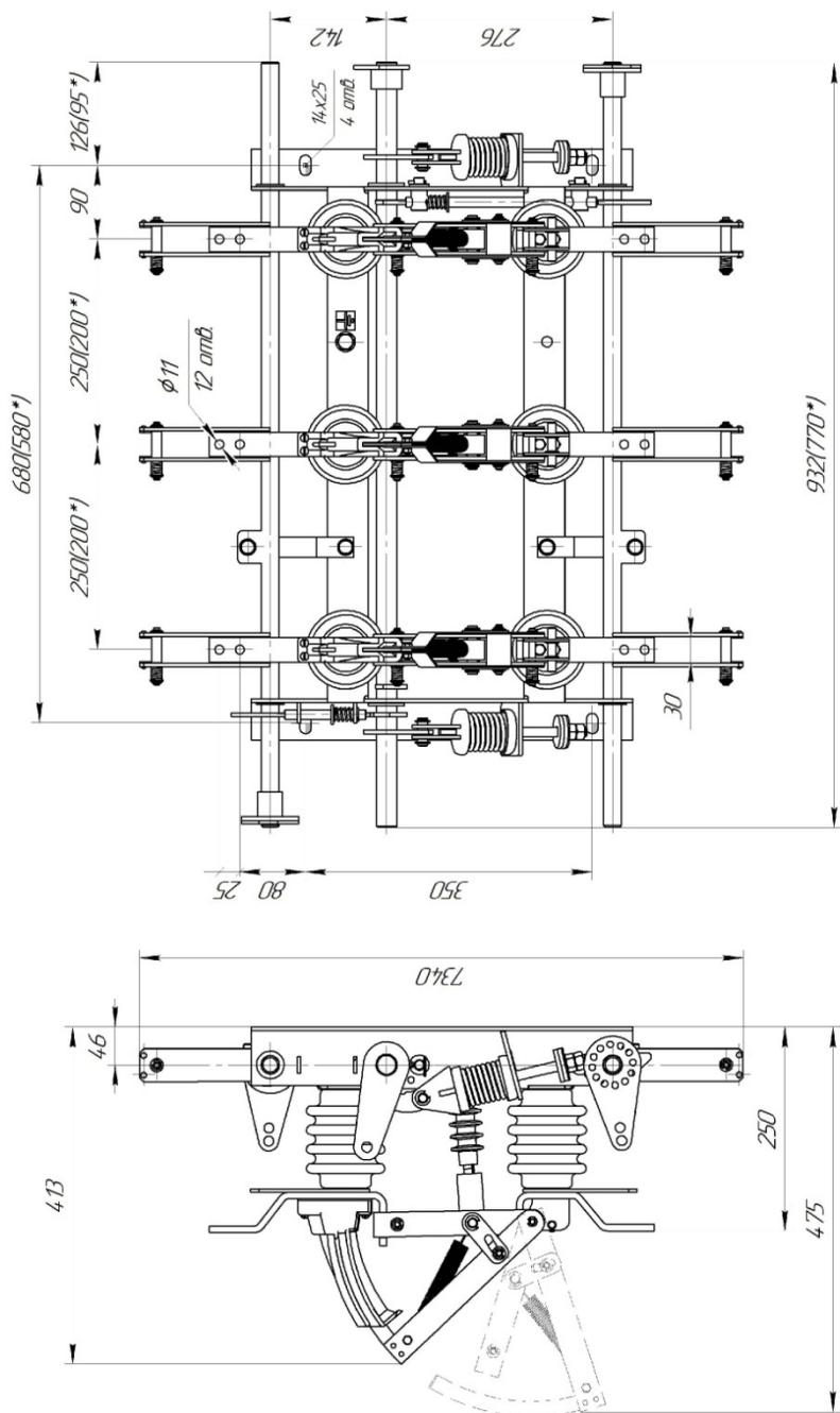
\* – размеры в скобках для выключателя с межполюсным расстоянием 200 мм (изготавливается по заказу)
