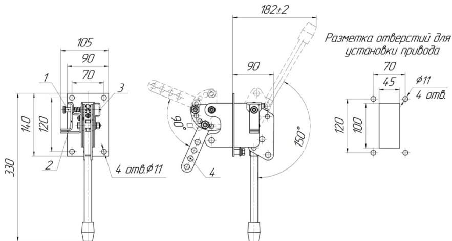
1-фиксатор положения рукоятки; 2-скоба фиксатора; 3-кронштейн для установки блок-замка; тяга.
