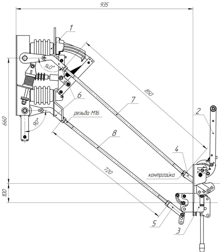
Рис. 9. Один из вариантов установки выключателя ВНРкз-10/630-II УХЛ2 в камеру КСО-366. Выключатель положение «вкл», заземляющие ножи положение «откл».
